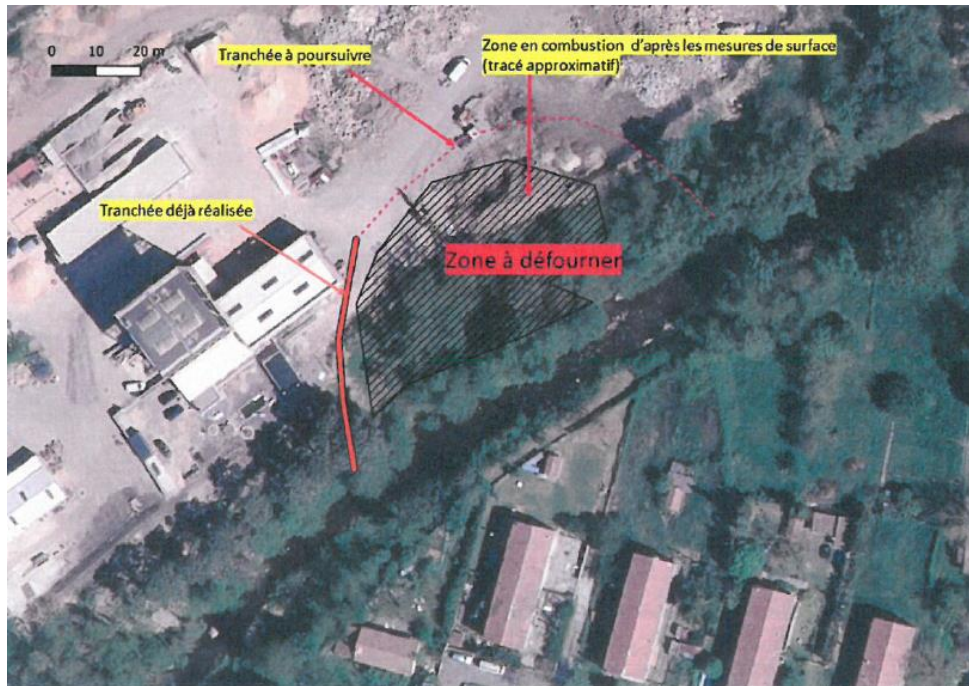
Figure 3 : Emprise de la zone de combustion et tracé approximatif de la tranchée envisagée par GEODERIS en Janvier 2020
